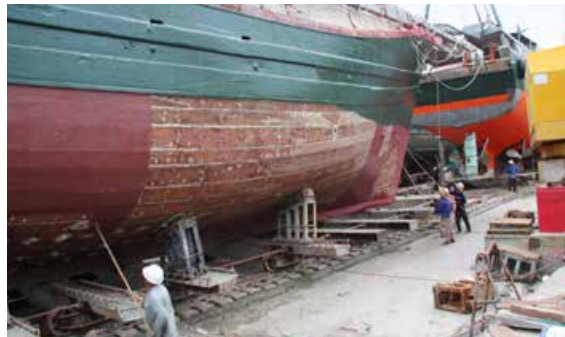
DANS UN CHANTIER NAVAL DE YANGJIANG CITY, PROVINCE DE GUANGDONG, DES TRAVAILLEURS APPLIQUENT UNE PEINTURE ANTISALISSURES SANS DDT À LA COQUE D'UN NAVIRE. PHOTO DE MME SHI SHENGMAN, FOREIGN ECONOMIC COOPERATION OFFICE (FECO).
