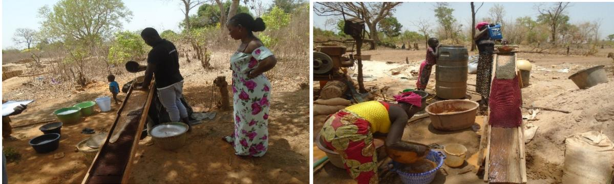
**Photo 15:** Lavage du minerai par le sluice
