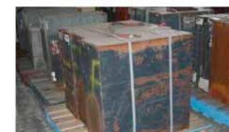
Fig. 39: Exemples de conditionnement incorrect avant le transport, ABRI<sup>26</sup>.
