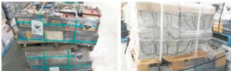
Fig. 41: Exemples de conditionnement incorrect avant le transport, ABRI<sup>26</sup>.
