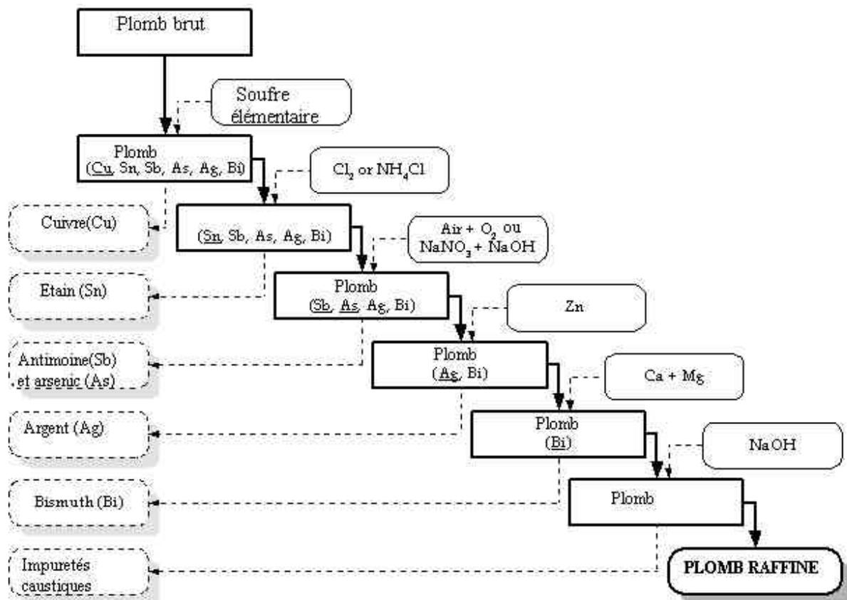
Figure 6: procédé pyrométallurgique d'affinage du plomb
