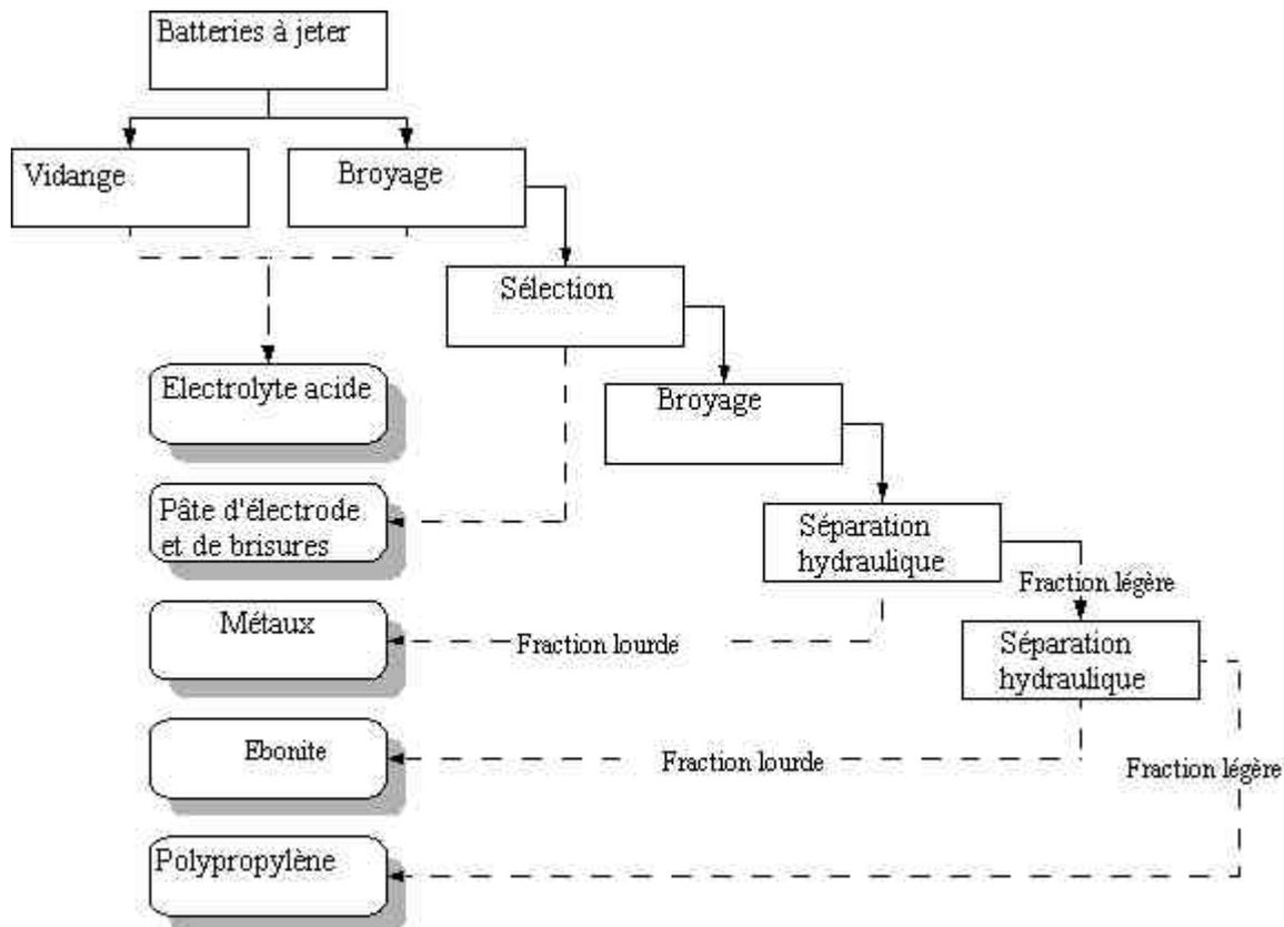
Figure 2 : Procédé de rupture des batteries
