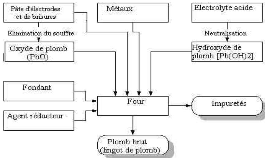
Figure 3 : diagramme d'un procédé de fusion du plomb
