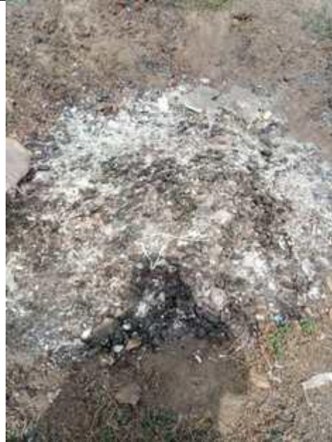
Photo 10 : Résidus de cendres issus du modèle d'incinérateur type De Montfort existant au CHP Nostè
