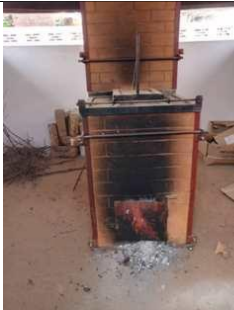
Photo 11 : Vue de face du modèle d'incinérateur type De Montfort amélioré par CDC dans un USP à Atakpamè
