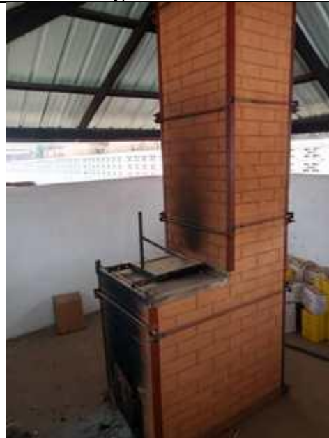
Photo 12: Vue de profil du modèle d'incinérateur type De Montfort amélioré par CDC dans un USP à Atakpamè
