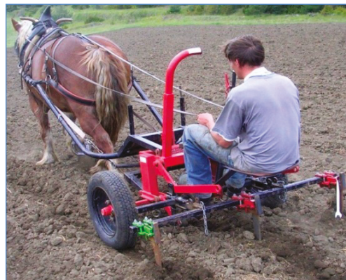
Outil de TA permettant un travail du sol puis ensuite un semis avec écartement constant entre lignes
