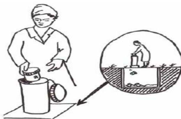
Figure 2: Fosse à déchets perforants (OMS, 2011)
