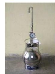
*Canister avec canne de prélèvement (manomètre au centre)*
